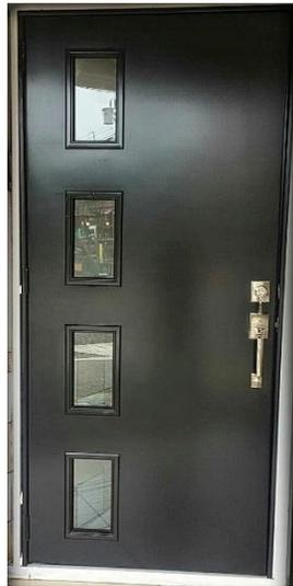
Puertas compactas de 4 cms de espesor, cubiertas con acero con doble chapa troquelada o lisa, con lamina calibre 24 (0.6mm), tratadas con proceso desengrasante y desincrustante, también tratadas con baño de fosfatos para cerrar el poro de metal y así evitar la corrosión. Pintadas con pintura en polvo horneable, núcleo de estructura de poliuretano expandido rígido, con una densidad de 32 a 34 kg/m<sup>3</sup>, que dado sus componentes opera como excelente aislante térmico, el cual no se deforma.
